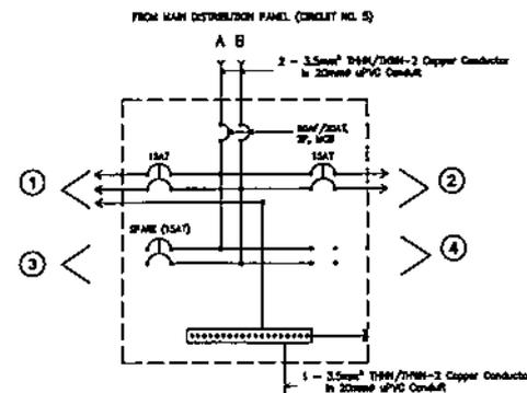
TO BE CONNECTED TO THE GROUND BUS BAR TERMINAL OF MAIN DISTRIBUTION PANELBOARD INSIDE THE CONTROL ROOM AT THE POWEROUSE
